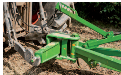
Genius-T zrusza warstwę gleby na głębokość 5–30 cm. Ponowne jej zagęszczenie zapewniają klinowe rolki ugniatające.
