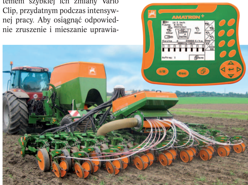
Wóz załadowczy Vario Trail 6000 stanowi bazę do montażu siewnika Citan oraz EDX o szerokości roboczej 6 m. Terminal Amatron+ ułatwia kontrolę pracy siewników Amazone oraz sterowanie dawkami wysiewu.
